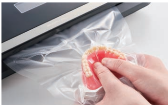
石膏模型、造形床、人工歯をセットし減圧密封したまま後重合
